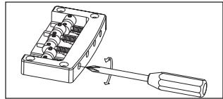
Die Intonation lässt sich einstellen, indem die Einstellschrauben hinten am Steg im Uhrzeigersinn gedreht werden, um den Reiter nach hinten zu verstetllen, oder gegen den Uhrzeigersinn, um ihn nach vorn zu verstetllen.
