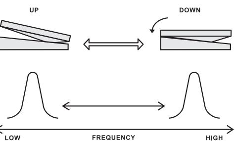
① ワウ効果は、フィルターの周波数レンジをペダルを踏み込んで変化させて得られます。(図参照) ペダルを踏み込むほど、高音域が強調されます。
